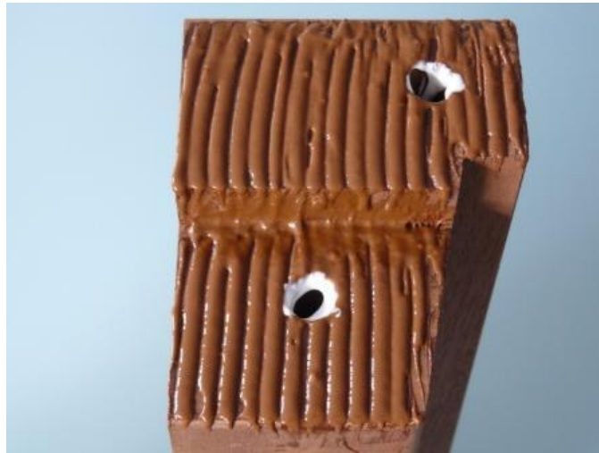
Foto 1 Deuvelgat met PVAc-lijm en rest DRYWOOD Opti-Joint XP
